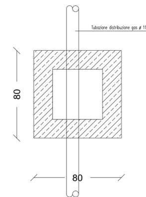
Pianta pozzetto linea gas
