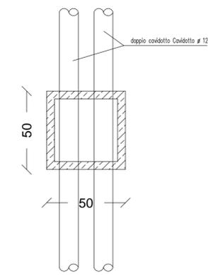
Pianta pozzetto linea telefonica
