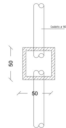
Pianta pozzetto linea elettrica
