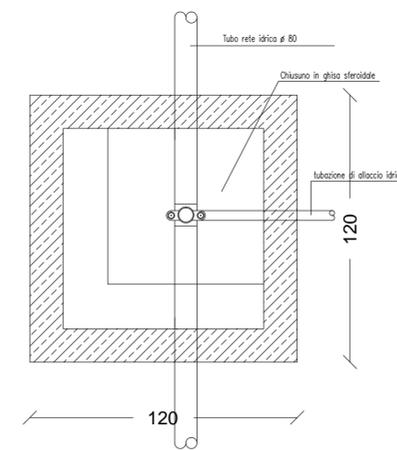
Pianta pozzetto linea idrica
